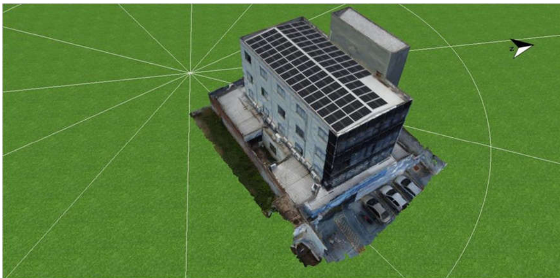
Figura 4.1 – Layout de disposição dos módulos fotovoltaicos
