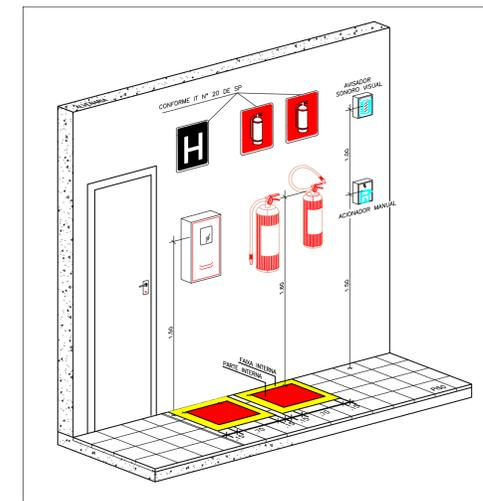
DETALHE INSTALAÇÃO CAIXA DE INCÊNDIO E EXTINTORES
